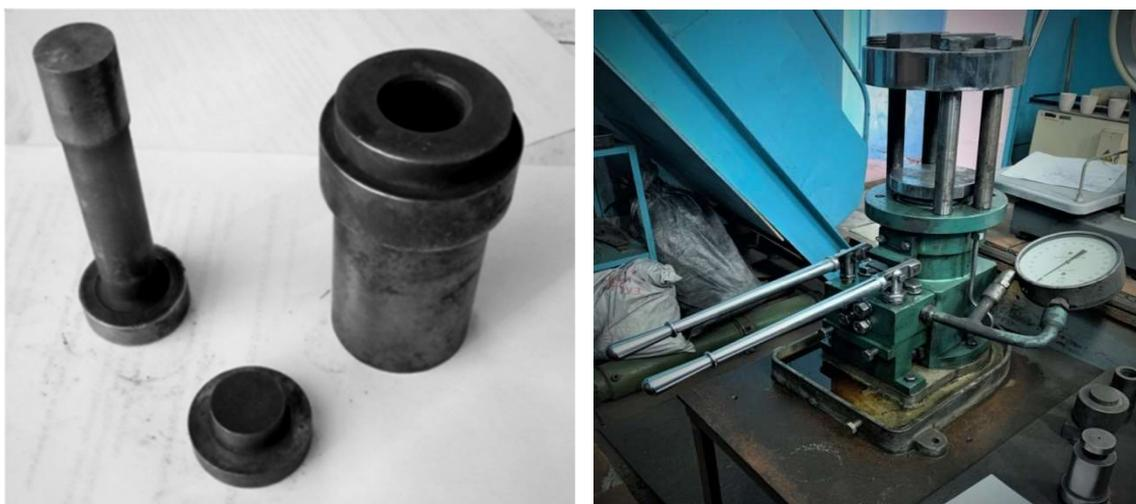
Рисунок 2.7 – Цилиндрическая пресс-форма с внутренним диаметром 23 мм и гидравлический пресс модели К-44-III
