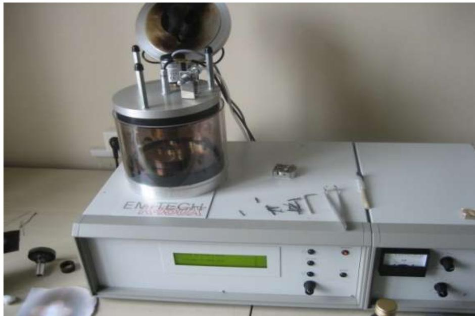
Рисунок 5.10 – Ионно-вакуумный напылитель
