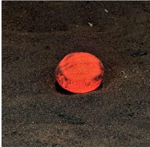
Рисунок 2.9 – Внешний вид образца при остывании после СВС на воздухе в песке
