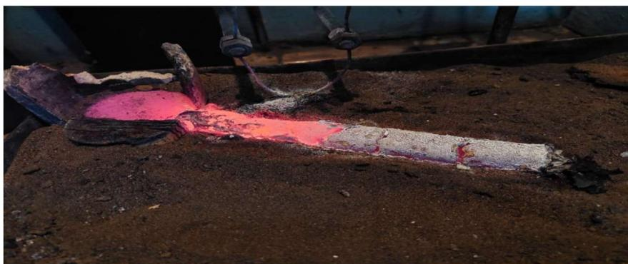
Рисунок 5.14 – Внешний вид после пропитки расплавом металла горячего пористого каркаса МАХ-фазы  $Ti_3SiC_2$  сразу после его синтеза [138]
