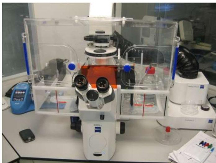
Рисунок 2.17 - Инвертированный микроскоп проходящего света с системой видеонаблюдения «Carl ZEISS Observer. A1»
