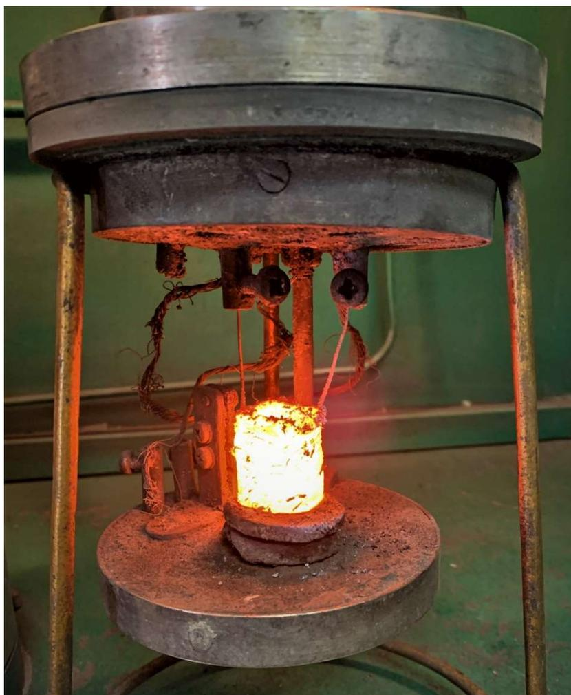
Рисунок 2.11 – Внешний вид раскаленного образца после СВС в реакторе
