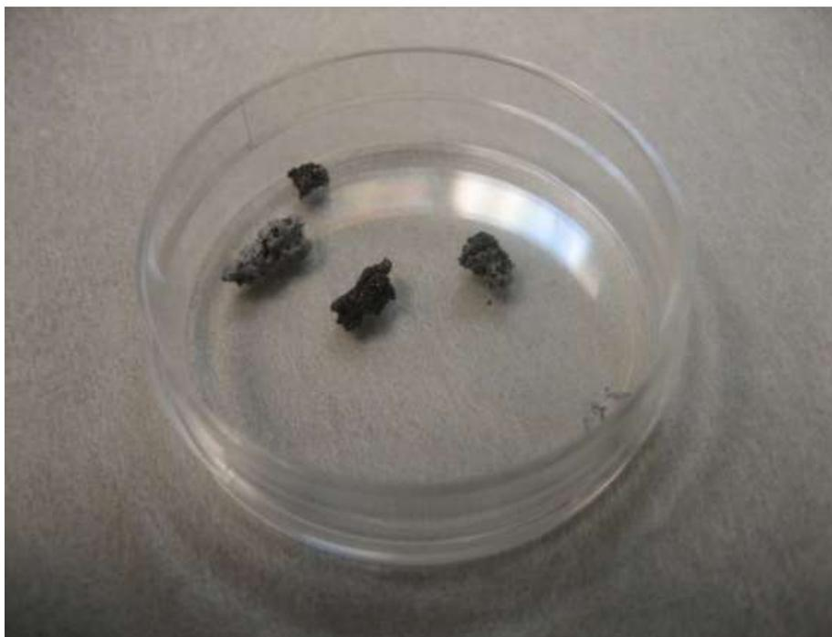
Рисунок 5.9 – Фрагменты образцов СВС-МАХ-фазы подготовленные для исследования на РЭМ
